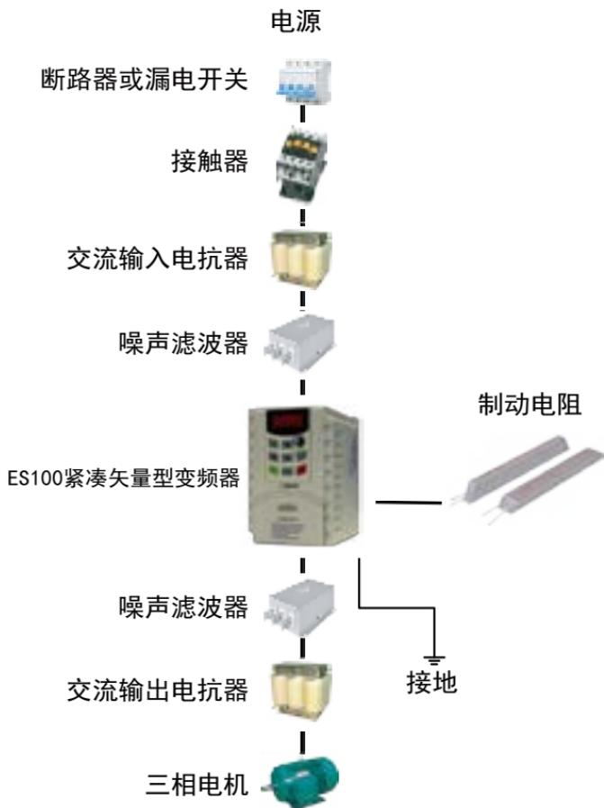
图 3-8 ES100 系列变频器与外围设备的接线图
